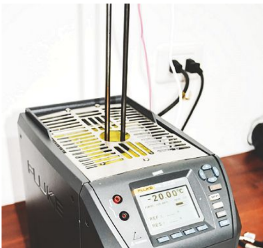
Figura 1 Calibración de una RTD por el método de comparación.
